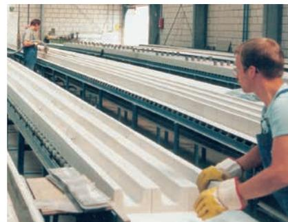
Bild 11: Ausrichten der KS-Sturz-Schalen.
