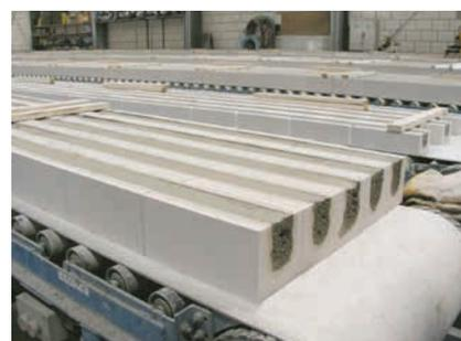
Bild 13: KS-Flachstürze nach dem Verfüllen.
